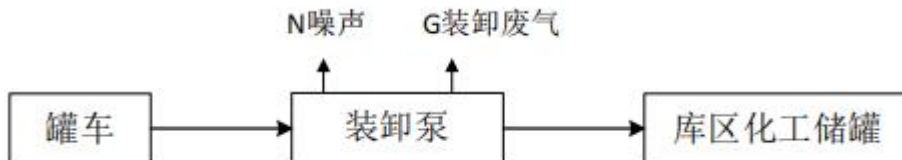
图 3-10 液体化工品卸车工艺流程及产污环节图
