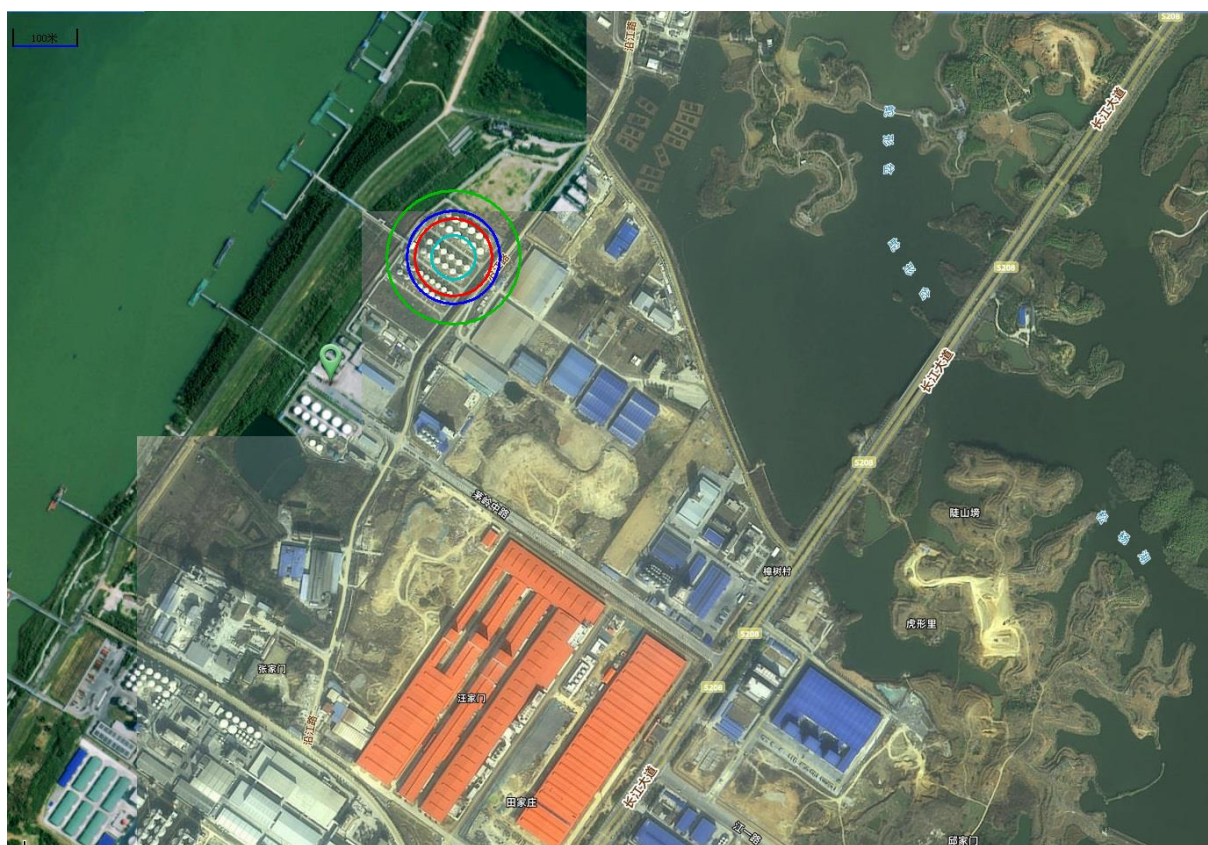
图 5.11-10 2000m 3 储罐甲苯容器整体破裂事故后果图
