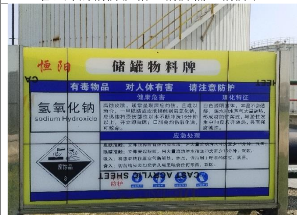
罐组旁的物料危险特性告知牌
